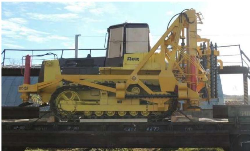
**Рисунок 1.9 – БТС-150Г в транспортном положении (на базе трактора ТС10 ГСТ)**
