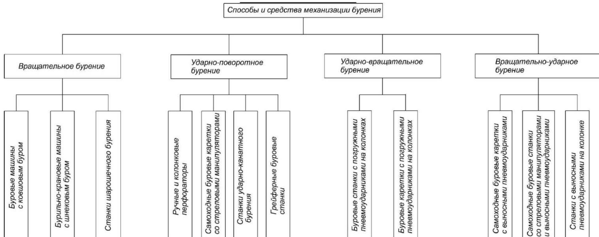
Рисунок 1.3 – Способы и средства механизации бурения
