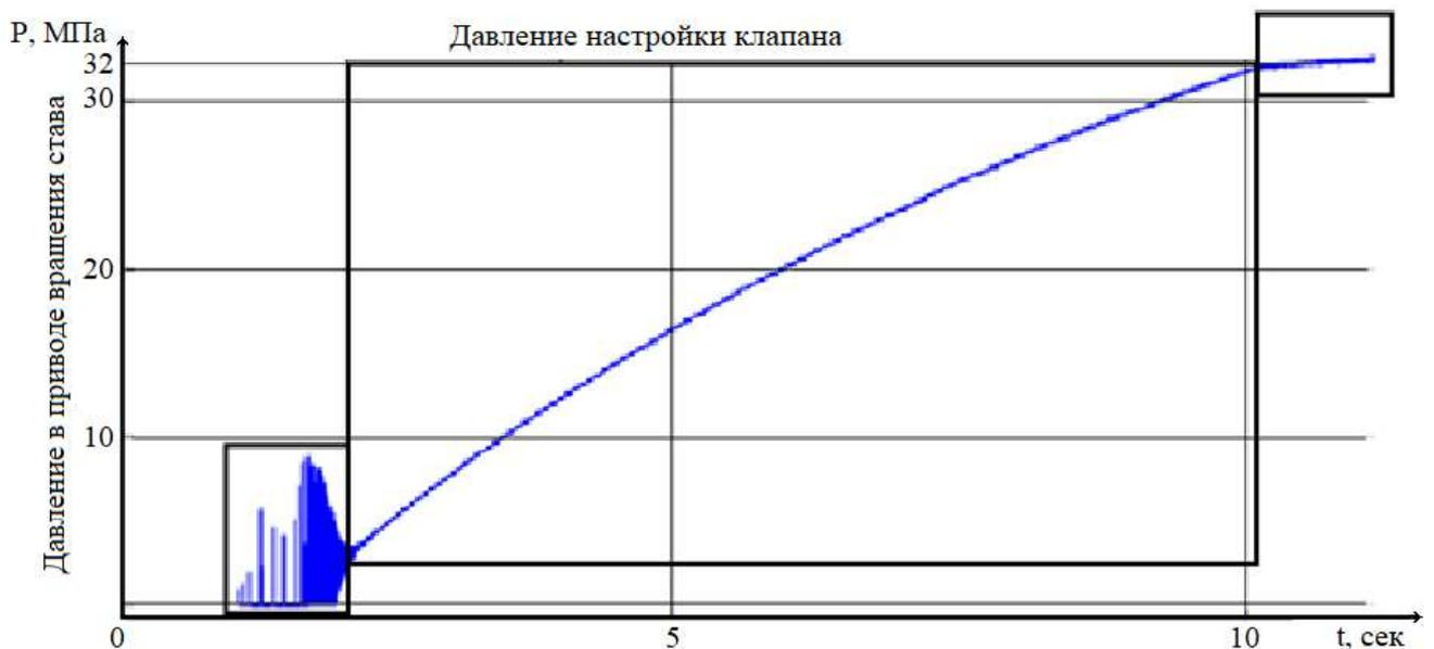
**Рисунок Д.1 – Изменение давления в гидроприводе вращения бурового става при осевом усилии 2 тс, при бурении трещиноватых пород VII категории с использованием низкомоментного гидромотора и редуктора**
