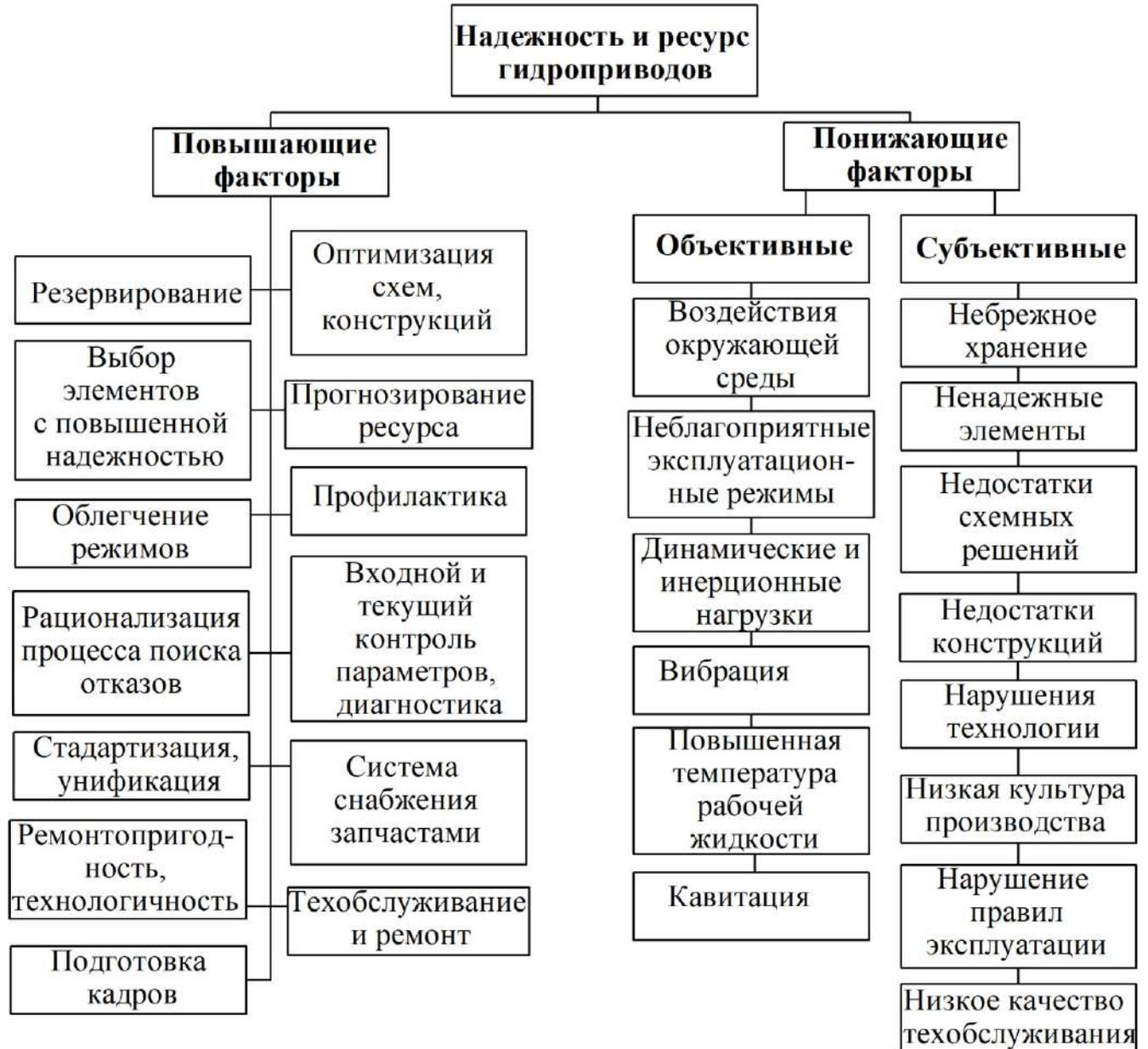
Рисунок 3.1 – Факторы, влияющие на надежность приводов машин
